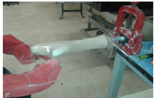
Figura 4 Hoja maleable sobre molde de yeso
