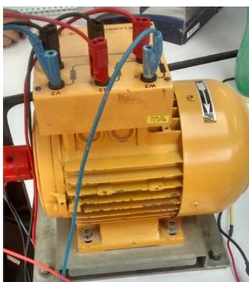
**Figura 5** Motor trifásico de 6 terminales
