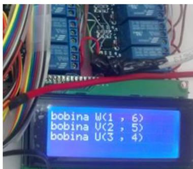
**Figura 8** Pantalla con los resultados obtenidos de la identificación de pares
