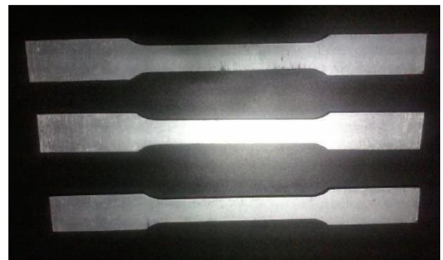
Figura 5 Probetas para pruebas destructivas
