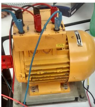
Figura 5 Motor trifásico de 6 terminales
