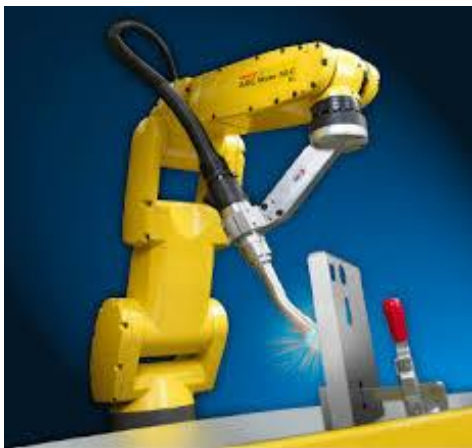
Figura 4 Aplicación de soldadura automatizada
