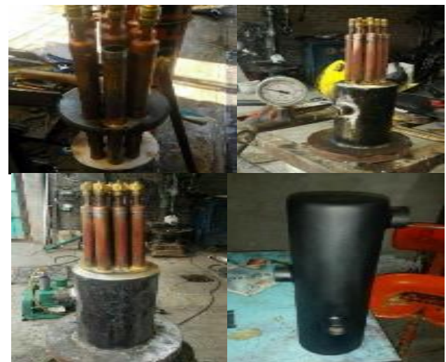
Figura 6 Ensamble de recuperador de calor con TTB
