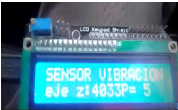
Figura 16 Lecturas registradas en el display del circuito ensamblado conectado al acelerómetro
