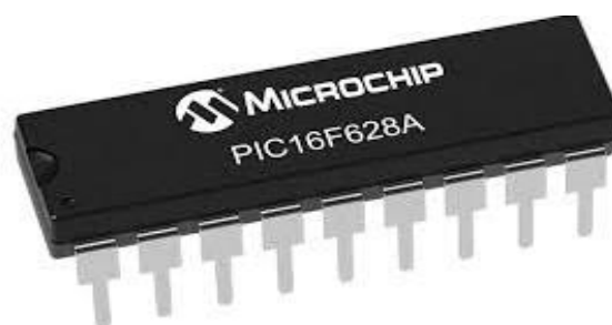
Figura 8 Controlador PIC 16f628A
