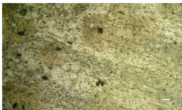
Figura 11 Imagen de aleación virgen sin tratamiento térmico
