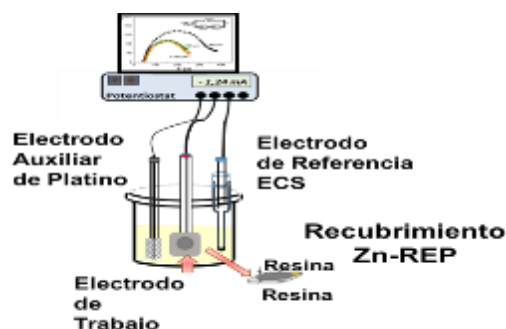
Figura 2 Esquema del arreglo de tres electrodos en la celda electroquímica
