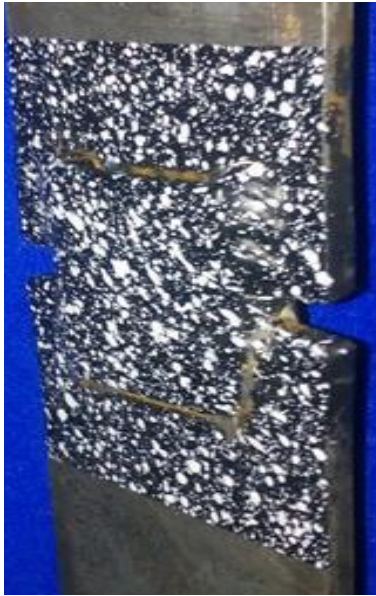
Figura 2 Manchado aleatoria en la junta soldada
