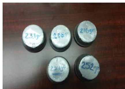
Figura 5 Imagen de las diferentes muestras tomadas durante la simulación del mini-horno
