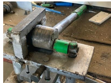
Figura 5 Parte superior del troquel
