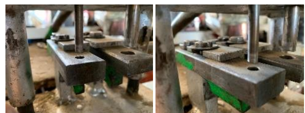
Figura 6 Soportes de perfiles de aluminio Fuente: Elaboración Propia
