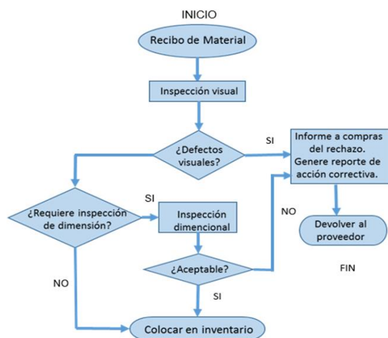
Figura 1 Diagrama de flujo para recepción de material
