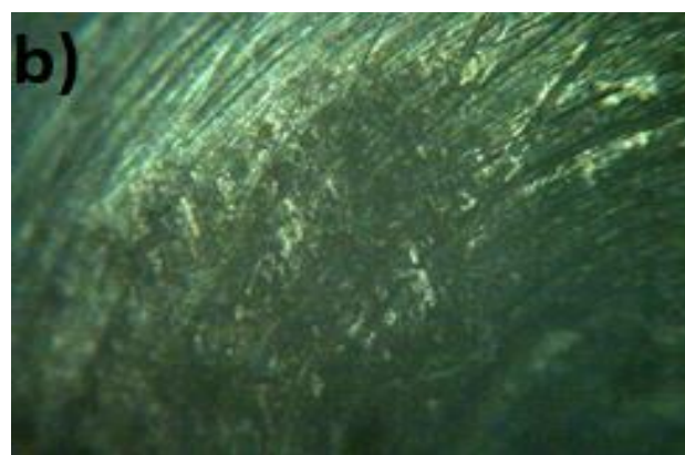
Figura 15 Microscopia de PIN (Acero AISI 4140), desgaste por contacto bola-plano, a) centro del pin, b) extremo del pin
