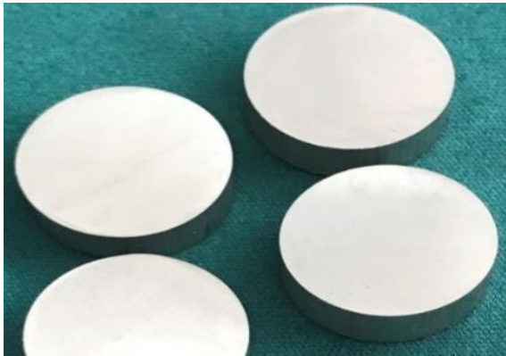
Figura 3 Acabado superficial de probetas de aluminio 6061
