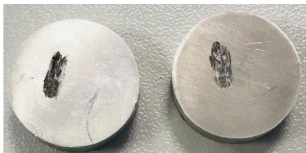
Figura 9 Huellas de desgaste en condiciones secas
