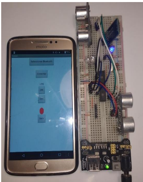
Figura 10 Circuito en funcionamiento conectado a la aplicación del móvil
