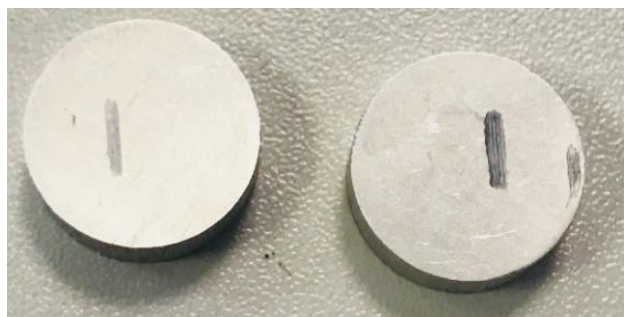
Figura 10 Huellas de desgaste en condiciones lubricadas
