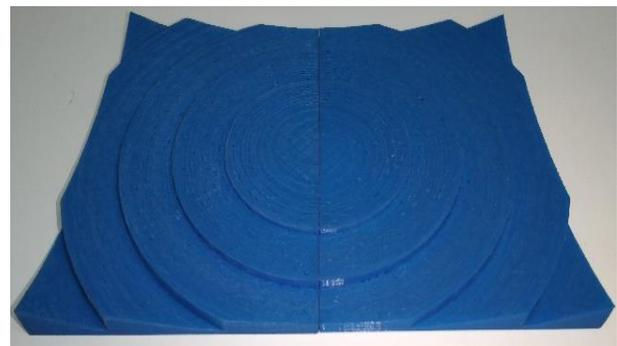
**Figura 3** Superficie de revolución impresa en 3D con material PLA
