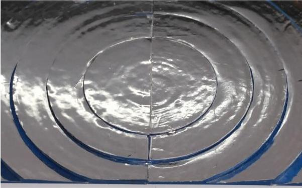
**Figura 4** Colocación del reflejante usando aluminio adherible para realizar las pruebas de concentración
