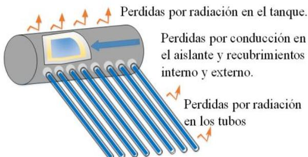
**Figura 1** Calentador solar de tubos al vacío.
