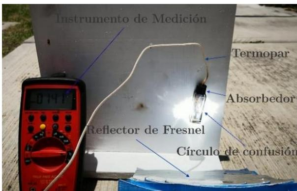
**Figura 5** Pruebas del modelo impreso en 3D de temperatura a una DFE en el punto de concentración de la radiación solar
