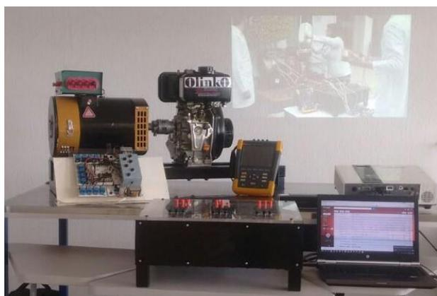
**Figura 1** Componentes del banco de pruebas de rendimiento electromecánico de biodiesel
