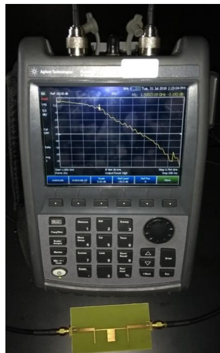
Figura 16 Parámetro S_{21} del filtro de microondas de circuito impreso
