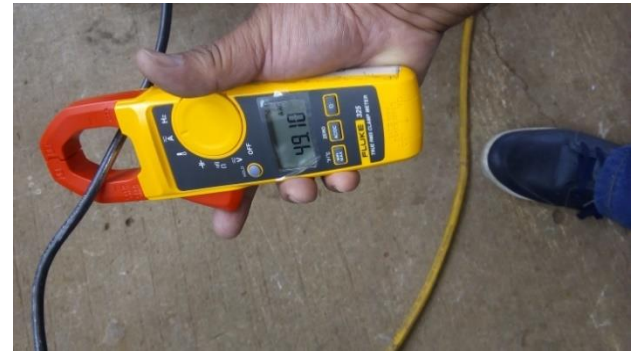
Figura 4 Mediciones de la corriente consumida por el electrodo Fuente: Elaboración Propia
