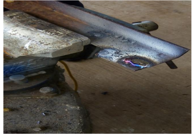
Figura 10 Soldadura Aplicada Fuente: Elaboración Propia
