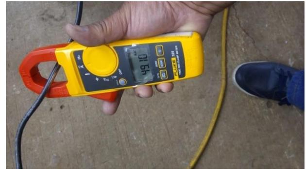
**Figura 4** Mediciones de la corriente consumida por el electrodo
