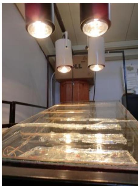
**Figura 2** Distribución de las charolas en el interior del secador solar
