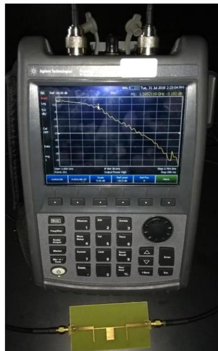
Figura 16 Parámetro  $S_{21}$  del filtro de microondas de circuito impreso
