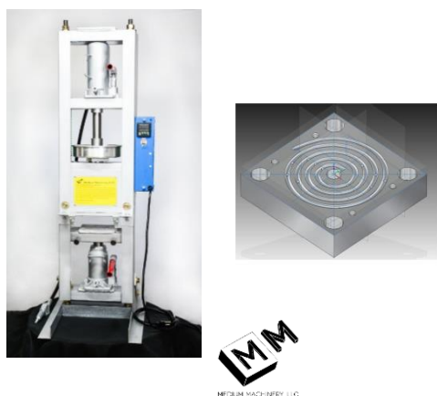
Figura 1 Equipo de moldeo por transferencia de MediumMachinery y esquema del molde de prueba de flujo en espiral ASTM D3123
