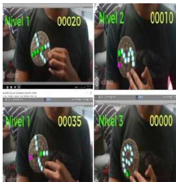
Figura 4 Uso del asistente empleando reconocimiento de patrones, técnica de autoexploración efectuada con cámara RealSense SR300® Fuente: Elaboración propia
