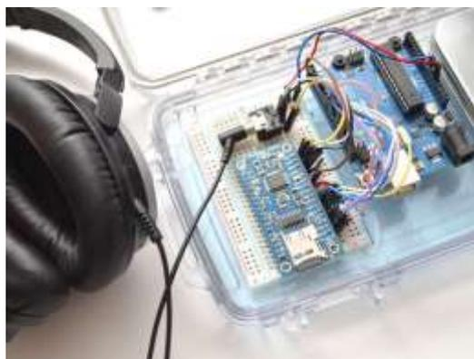
**Figura 2** AdaFruit MP3 Shield para Arduino
