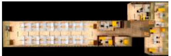
Figura 15 Vista Ray-Trace de la planta arquitectónica del tercer nivel con las luminarias encendidas del rediseño de iluminación
