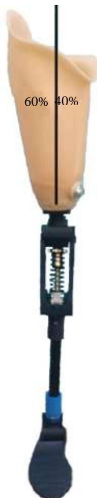
**Figura 22** Vista frontal del prototipo de prótesis transfemoral
