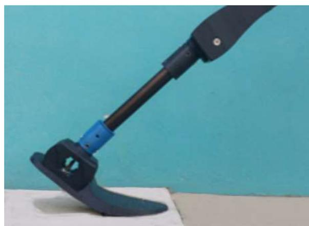
Figura 25 Protótesis sometida a dorsiflexión
