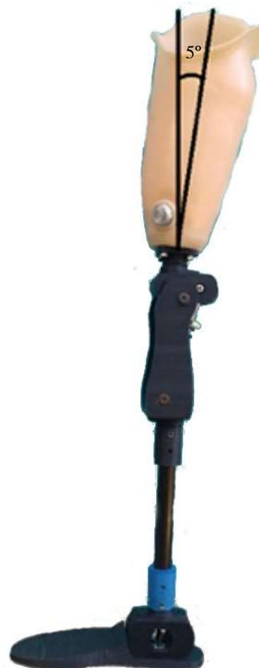
**Figura 23** Vista sagital del prototipo de prótesis transfemoral
