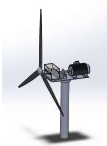
**Figura 1** Componentes de un Aerogenerador
