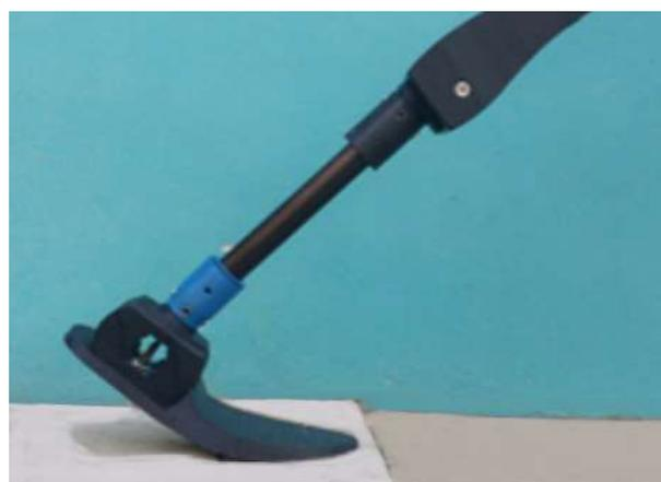
Figura 25 Protótesis sometida a dorsiflexión
