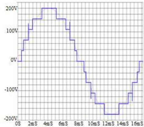
Figura 12 Onda generada por el inversor de 11 niveles de voltaje
