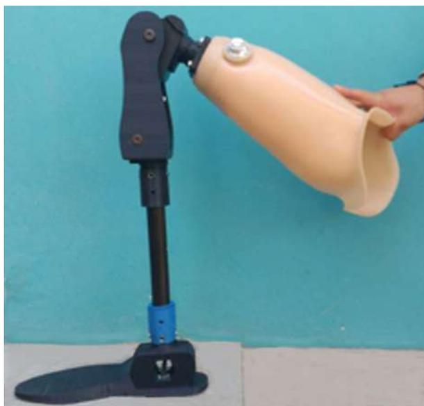
Figura 24 Protótesis sometida a flexión
