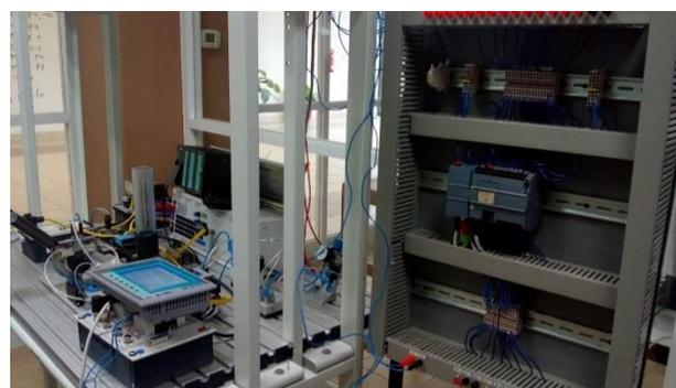
**Figura 7** Comunicación Pantalla HMI y PLC S1200, pruebas de forzado de variables de salida
