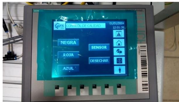
**Figura 10** Implementación de Pantalla HMI, para el forzado directo de señales digitales
