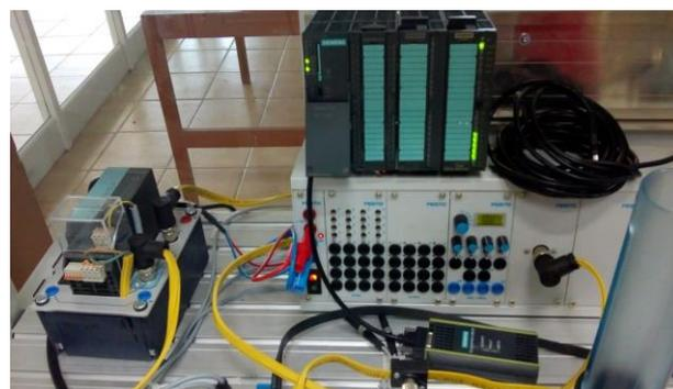
a) Implementación de un PLC S300 con comunicación MPI y tarjeta de Red ASI
