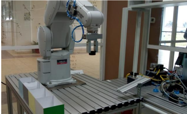
Figura 8 Selección de piezas de trabajo, en relación a su color en base a la pantalla HMI
