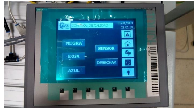
Figura 10 Implementación de Pantalla HMI, para el forzado directo de señales digitales
