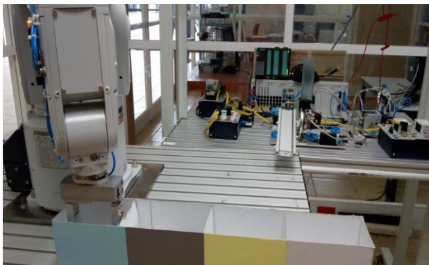
Figura 9 Clasificación de fichas, una vez que el Robot sabe el color de la pieza de trabajo se clasifica en los contenedores asignados
