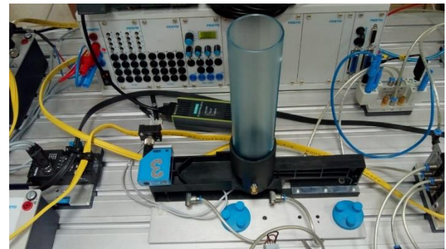
Figura 10 El sistema cuenta con sensores de presencia que permiten mantener en espera "stand by"
