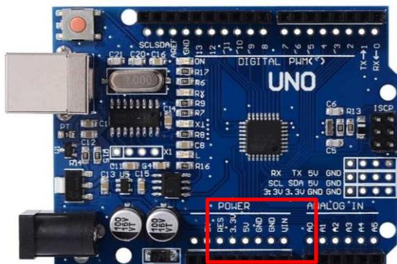
**Figura 1** Tarjeta Arduino Uno Pines de Alimentación
