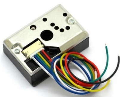
Figura 2 Sensor de polvo Fuente: Elaboración Propia
