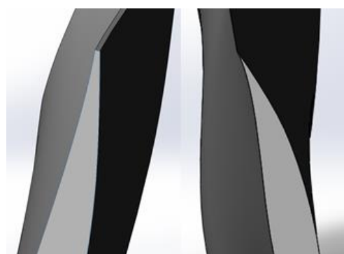
Figura 5 Pala con borde de salida plano de 1.5 mm y pala con borde de salida en punta
