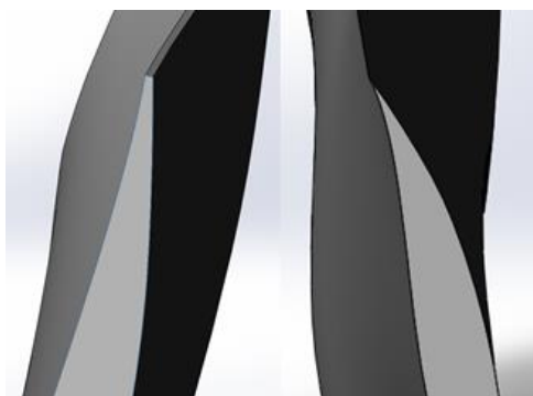
Figura 5 Pala con borde de salida plano de 1.5 mm y pala con borde de salida en punta Fuente: Elaboración Propia
