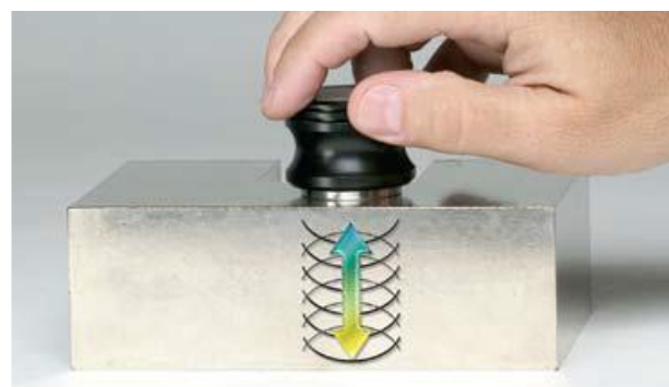
Figura 1 Principio de operación del ultrasonido Fuente: (Olympus Corporation, 2011)
