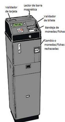
**Figura 1** Partes principales de un Farebox comercial. Fuente: [6]
