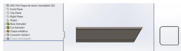
**Figura 7** Modelo en 3D del gabinete como chapa metálica ("sheet metal"). (Elaboración Propia)
