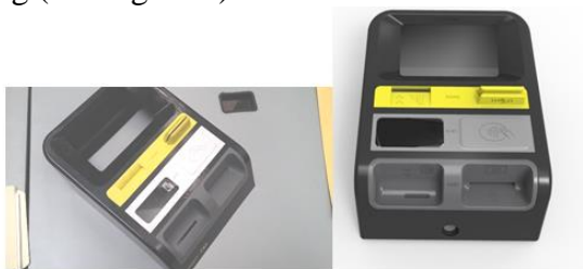
Figura 6 Interfaz de módulo de pago con pantalla LCD del farebox (ver Figura 1). (Elaboración Propia)
