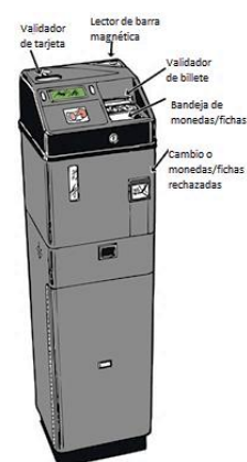
Figura 1 Partes principales de un Farebox comercial. Fuente: [6]
