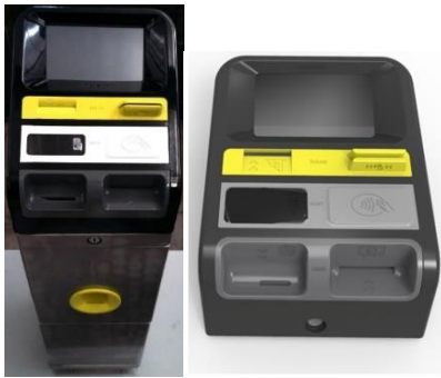
Figura 3 Prototipo de la interfaz del sistema de cobro instalado en el farebox. (Elaboración Propia)
