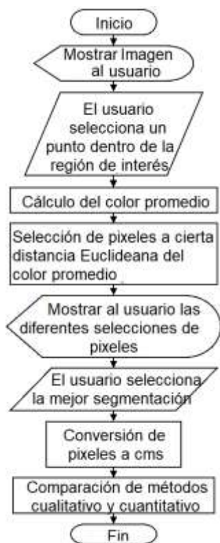
Figura 5 Diagrama de flujo indicando los pasos generales para hacer el método de medición cuantitativo
