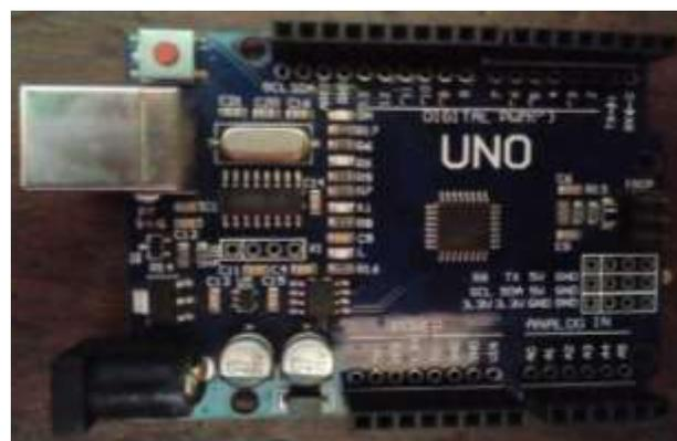
**Figura 2** Figura física del Arduino Uno
