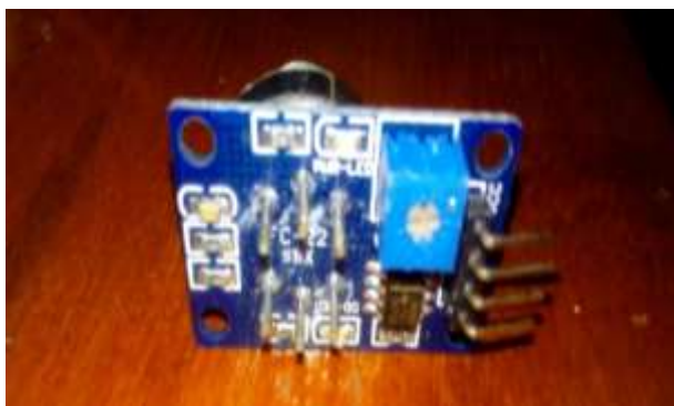
Figura 5 Figura física detrás del Sensor de gas combustible y humo MQ-2
