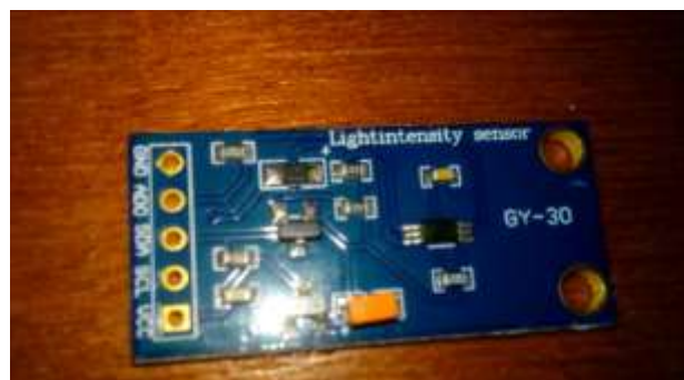
Figura 3 Figura física del Sensor de Iluminación Digital BH1750
