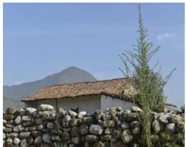
**Figura 6** Vivienda vernácula con cubierta de vigas y morillos de madera con teja de barro de media caña
