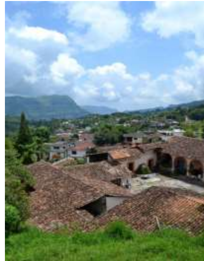
Figura 2 Conjunto de viviendas típico en un solo lote alrededor del patio, habitadas por personas de la misma familia. Se puede observar las áreas de tendido de ropa comunales; marcos en puertas, pórticos en la vivienda principal y los techos inclinados a dos aguas de vigas de mara con teja de media caña. Fuente: HERNÁNDEZ (2018).
