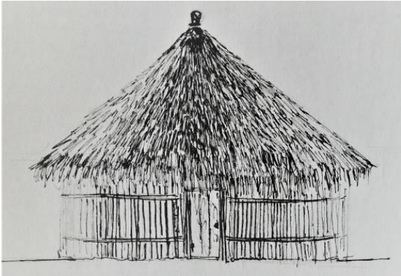
Figura 5 Muros de otate y cubierta de palma. Ejido la Lima
