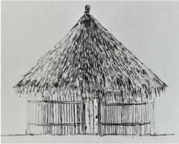
Figura 2 Muros de otate y cubierta de palma. Ejido la Lima
