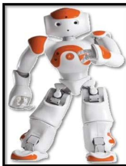
Figura 2 Robot humanoide NAO H25.
