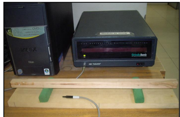
Figura 1 Dispositivo para pruebas no destructivas de vibraciones transversales y aparato Grindosonic ® (Sotomayor-Castellanos et al. 2007).
