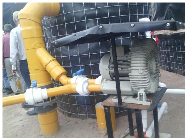
**Figura 15** Sistema de purificación de Biogás y compresión constante
