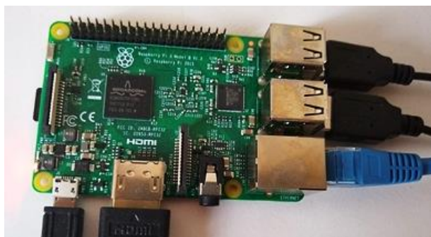
Figura 7 Conectando los componentes asociados a la computadora Raspberry Pi Fuente: Elaboración propia
