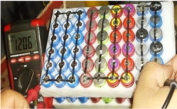
Figura 4 Circuito Serie-Paralelo de celdas de batería Fuente: elaboración propia
