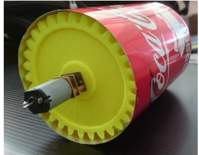
Figura 8 Prueba de integración motor-llanta y tamaño Fuente: Elaboración Propia
