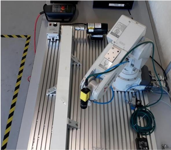
**Figura 2** Ensamble de la cámara, robot y ventosa neumática
