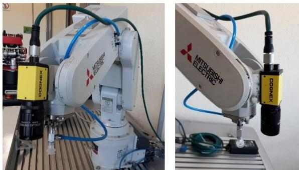
**Figura 3** Detalle del ensamble de la cámara y la ventosa neumática
