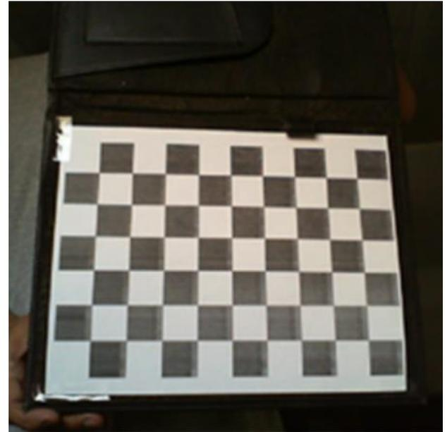
**Figura 2** Patrón de calibración
