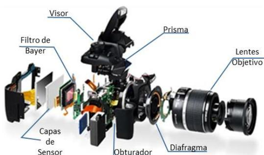
**Figura 1** Elementos de una cámara Réflex (“Como funciona una cámara”, 2014)
