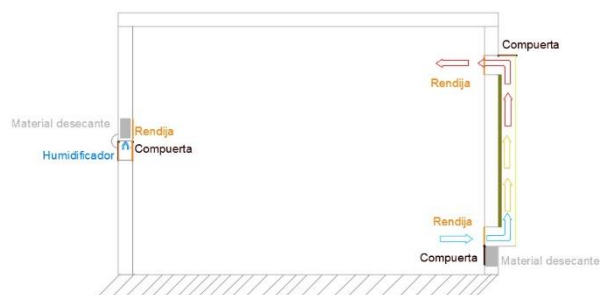
Figura 2 Proceso de calentamiento
