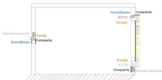
Figura 4 Proceso de calentamiento con humidificación
