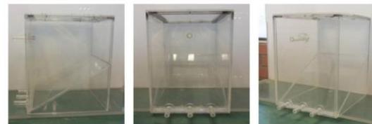
**Figura 1** Cámara de impacto elaborada en acrílico.
