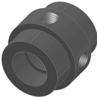
**Figura 1** Diseño de cople porta-probeta en SolidWorks 2014
