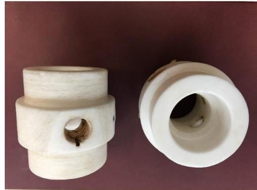
**Figura 2** Cople porta probetas elaborado en teflón
