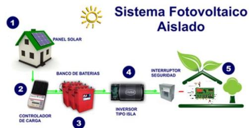
Figura 1 Diagrama de sistema fotovoltaico aislado
